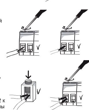
При подключении одного проводника сечением 0,5 мм<sup>2</sup> к автоматическому выключателю с пружинными клеммами, необходимо установить на подключаемый конец жилы обжимной наконечник (при помощи обжимного инструмента) перед затягиванием клеммных винтов.
