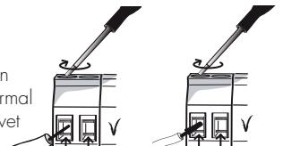
Hvis lederen (0,5 mm<sup>2</sup>) skal tilkobles en plateklemme, kan tilkobling skje på normal måte eller med metallhylse som beskrevet over.
