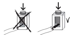
Медный проводник сечением 0,5 мм<sup>2</sup> подключают одним из следующих способов:
