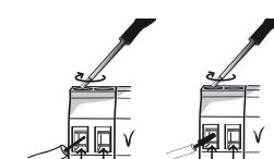
Jos kytket yhden johtimen ( $0,5 \text{ mm}^2$ ) pylväsliitintään käyttämällä painelevyä, johdin voidaan liittää ja kiinnittää normaalisti  $1,0 \text{ mm}^2$ :n johtimen tapaan tai metallisella puristimella.
